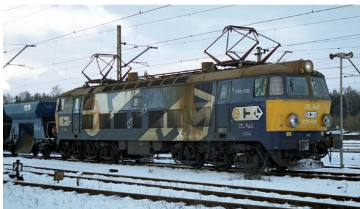
Fot. 5. Lokomotywa ET21-R001, to maszyna sprowadzona z Maroka i przebudowana w ZNTK Oleśnica. Nowa Wieś Wielka, 27.01.2007 r. Fot. G. Kotlarz
