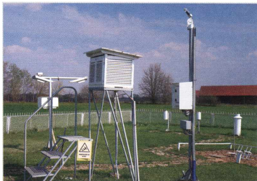
Ogródek meteorologiczny to płaski, ogrodzony, porośnięty trawą teren o wymiarach 15 x 15 m. Przyrządy do pomiaru temperatury i wilgotności powietrza oraz ciśnienia atmosferycznego znajdują się w klatce meteorologicznej umieszczonej na wysokości 2 m nad poziomem gruntu.
