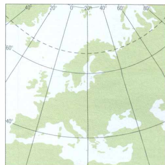
Siatka kartograficzna w odwzorowaniu stożkowym normalnym.
