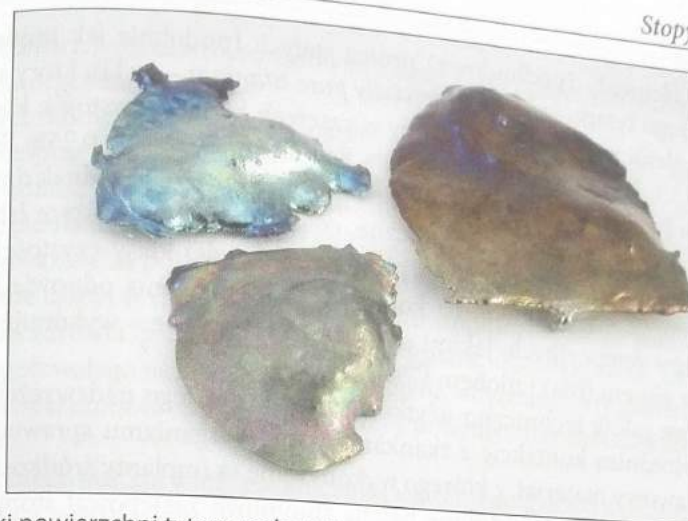
Ryc. 18. Próbkki powierzchni tytanu pokrytej warstwą tlenków.
